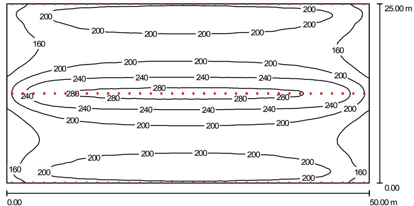
Altura del local: 8.000 m, Altura de montaje: 6.000 m, Factor mantenimiento: 0.80
